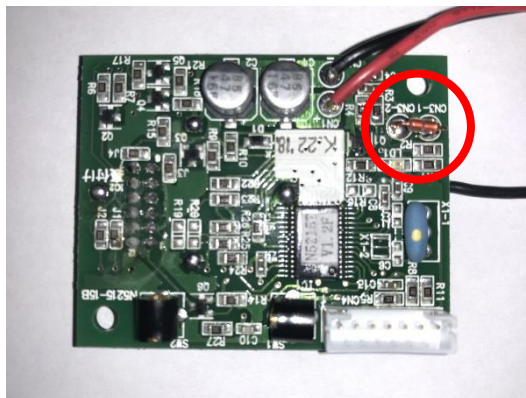
図5-2 温度素子を付加した行動量センサー基板
