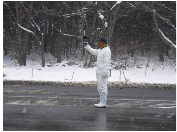
写真 34 : C3 地点ニオイセンサー測定状況 (近景)
