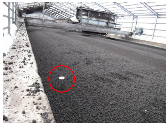
写真 28 : 堆肥の発酵温度測定状況 (-1.0m)
