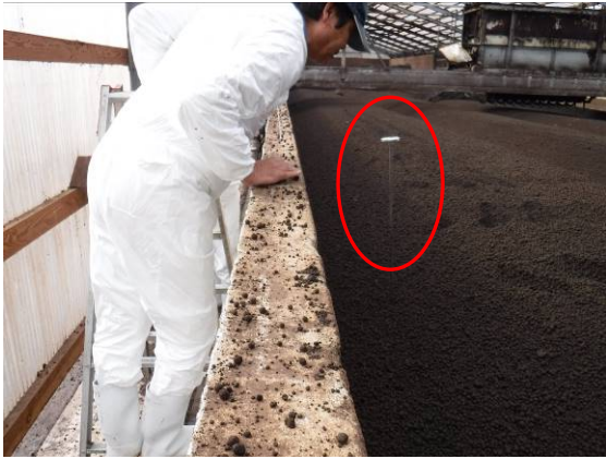
写真 27 : 堆肥の発酵温度測定状況 (-0.3m)
