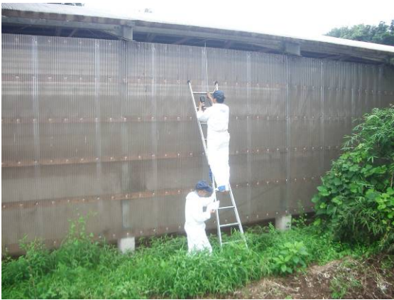
写真 21：堆肥舎開放面上部の流速測定状況（遠景）
