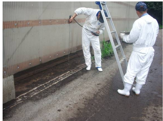
写真 24：堆肥舎開放面下部の流速測定状況（近景）
