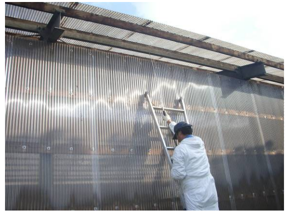
写真 22：堆肥舎開放面上部の流速測定状況（近景）
